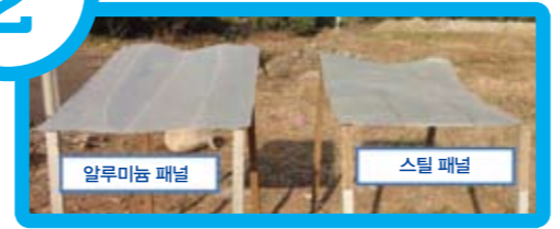
태양열 아래에서 한 시간 단위로 각 재료의 상·하면의 온도 측정
